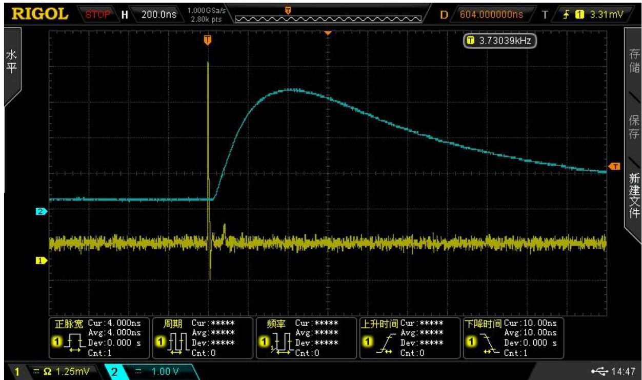
为了保证脉冲频率测量正确，调节模块电位器使得 DET 口输出脉冲峰峰值大于 2.5V（注意，DET 输出约有 0.5V 的偏置电压）。
